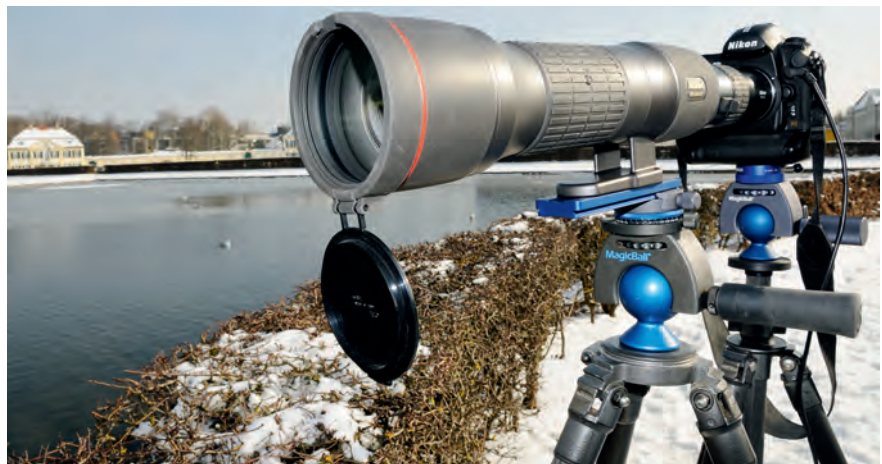
Nikon Fieldscope EDG 85 mit Nikon Fieldscope Digital SLR Camera Attachment FSA-L2 montiert an einer Nikon D3x. Die Kamera wird zusätzlich über ein weiteres Dreibeinstativ stabilisiert.
