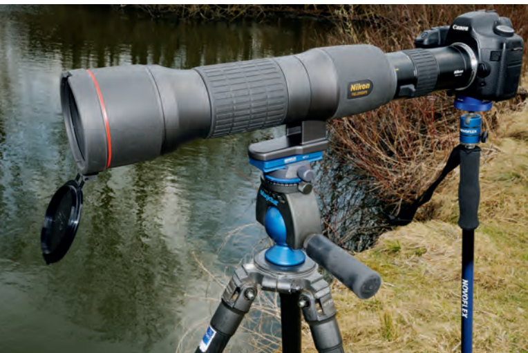
Nikon Fieldscope EDG 85 mit DSLR-Adapter FSA-L2 montiert an einer Canon EOS 5D über den Novoflex Adapter EOS/NIK. Die Kamera wird zusätzlich über ein Einbeinstativ (Novoflex Teleskopwandlerstock BBSTOCK) stabilisiert.
