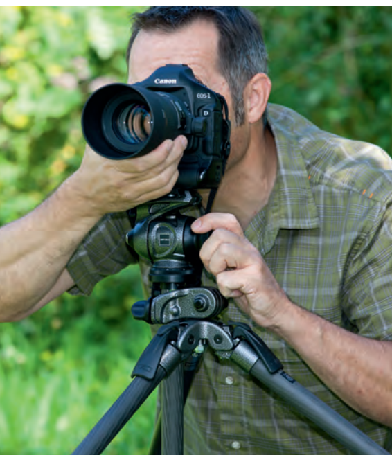
Bei Filmen mit der digitalen Spiegelreflexkamera spielt der Einstellknopf seine Vorteile aus. Während die linke Hand die Fixierung bedient, führt die rechte Hand die Schärfe nach.
