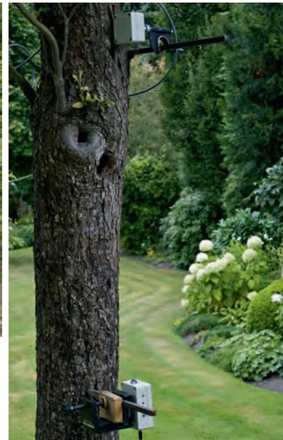
Anordnung der einstrahligen Infrarotlichtschranke an einer Spelchöhle.
