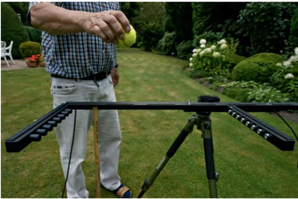
Anordnung zum Messen des Vorhaltemasses. In einem Abstand von 0,5m wird ein Tennisball durch die Flächenlichtschranke fallen gelassen.
