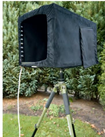
Flugtunnel mit integriertem Lichtschrankenvorhang. Acht Infrarot-Sender und Empfänger tasten eine Fläche von 45 x 30 cm ab. Sie bilden ein dichtes Gitter von Infrarotstrahlen, und das fliegende Objekt kann den Strahlenvorhang nun oben, unten, rechts oder links durchfliegen, die Kamera wird immer ausgelöst.
