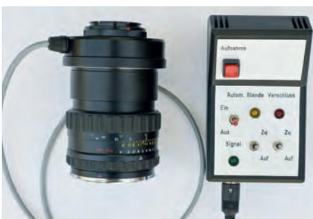
Nikon D3S mit Objektivadapter, um die Rolleiflex-Objektive Zeiss-Planar PQS verwenden zu können. Die Elektroniksteuerung steuert den Zentralverschluss und Blendensteuerung. Der Verschluss wird verzögerungsfrei ausgelöst.
