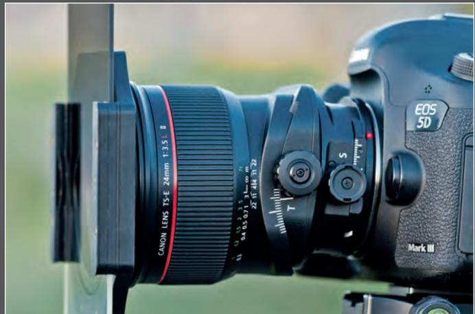
Die Tilt- und Shiftfunktion lässt sich beim Canon TS-E 24 mm f/3,5 II frei und unabhängig voneinander voll um die optische Achse drehen. Kleine Rädchen und zwei Skalen helfen bei der Justierung.
