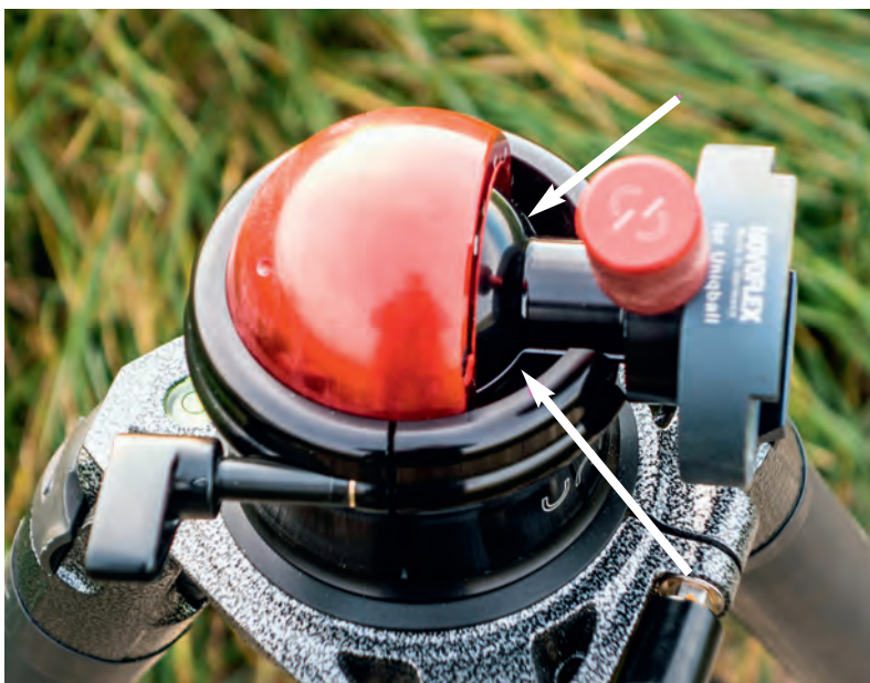
Befindet sich die rote Kugel in der 90°-Position, kann an den markierten Stellen sehr leicht Schmutz eindringen.
