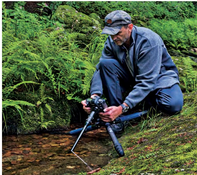
Die wasserdichte Bauweise des Objektivs erschließt viele neue Motive im nassen Element: Ein Eintauchen des Objektivs in das Wasser ist bis zum Anschluss des USB-Kabels der LED-Lichter möglich. Der lange Tubus erleichtert das Arbeiten in relativ bequemer Position.
