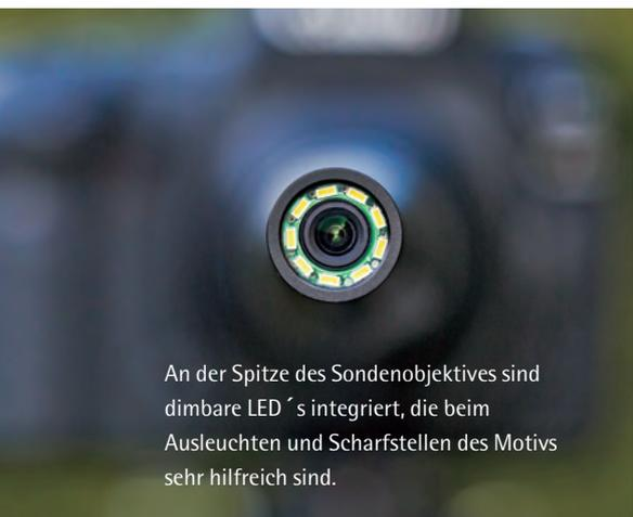
An der Spitze des Sondenobjektives sind dimbare LEDs integriert, die beim Ausleuchten und Scharfstellen des Motivs sehr hilfreich sind.
